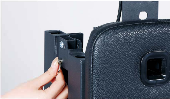
9. Indsæt to støttetifter i sidehullerne på begge sider for at låse stålrammen.
