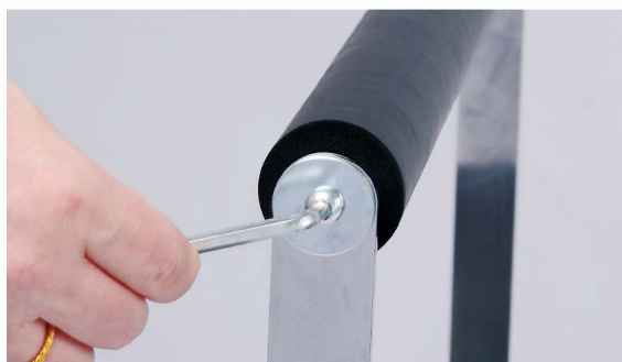
20. Spænd pakningerne til to sider og med en unbrakonøgle.
